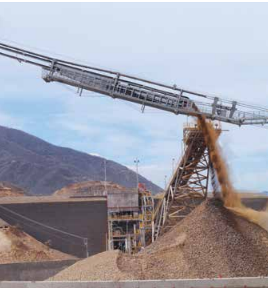
Yükleme istasyonu ve stok boşaltma noktası arasındaki tek direk 44 m yüksekliktedir.
