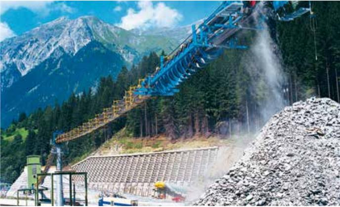
**2001** Le système RopeCon® est mis en œuvre pour la première fois. L'installation de Strengen, Tyrol, a transporté entre 2001 et 2004 quelque 850 000 m<sup>3</sup> de déblais d'excavation au-dessus d'une voie rapide, d'une voie de chemin de fer et d'une rivière.
