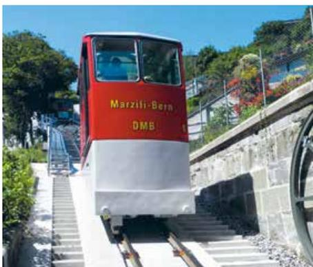
Les passagers vont découvrir un nouveau confort : il n'y a plus aucun obstacle à l'embarquement, et les portes ont été élargies pendant la révision des véhicules. Le flux optimisé des personnes agit positivement sur la capacité de transport et sur la fréquence.
