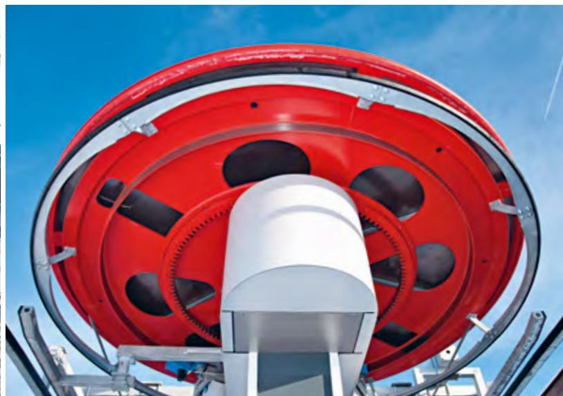
Le seggiovie offrono un'ampia gamma di opzioni. L'argano può essere disposto nella stazione a monte o in quella a valle, in una struttura completamente coperta oppure in una soluzione compatta sotto alla puleggia motrice, il sistema ChairDrive. Le caratteristiche sorprendenti del ChairDrive sono la chiara disposizione dei vari componenti e la loro costruzione compatta, che rendono l'installazione e trasporto molto semplici ed efficienti.
