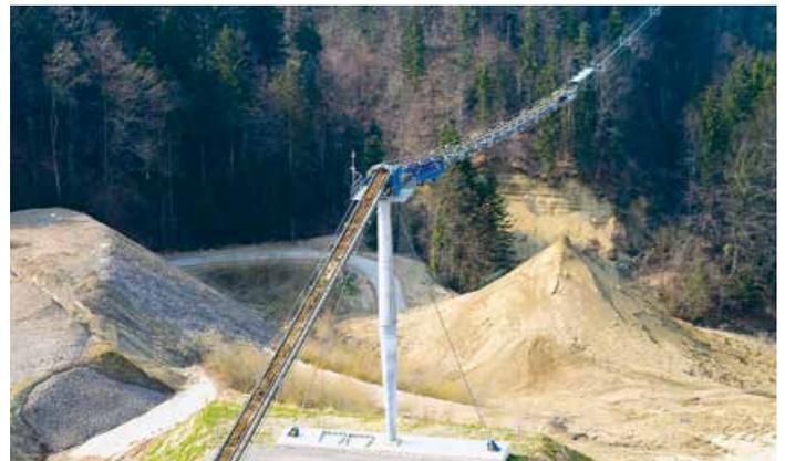
**2016** Die seit 2005 betriebene RopeCon® Anlage auf der Deponie Tüfentobel bei St. Gallen (CHE) wird durch eine zweite, direkt ins Seilfeld gehängte RopeCon® Anlage erweitert. Die Materialübergabe erfolgt in ungefähr 20 m Höhe.
