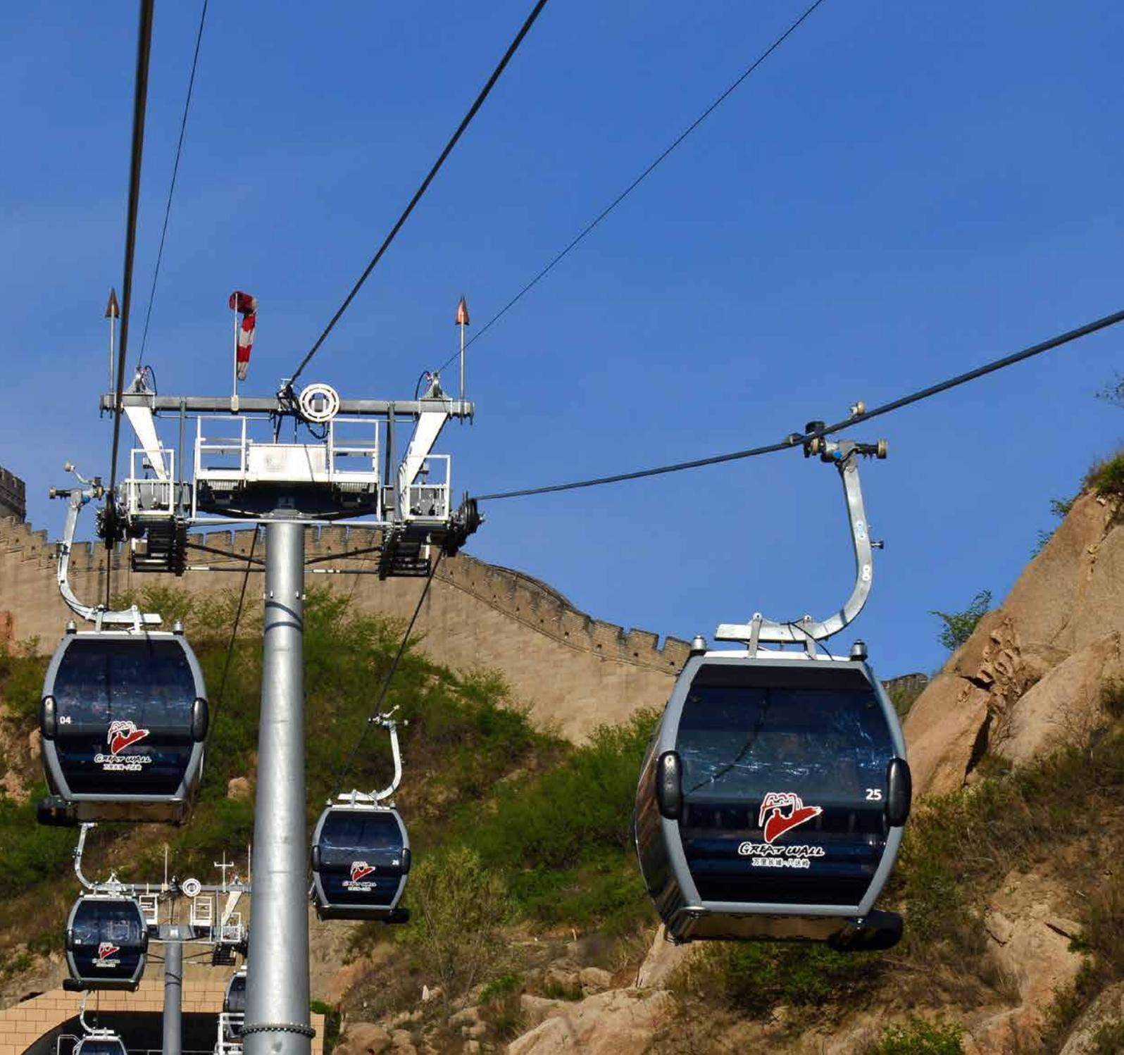
komfortable und dreimal so leistungsstarke 8er-Gondelbahn mit niveaugleichem Einstieg ersetzt.
