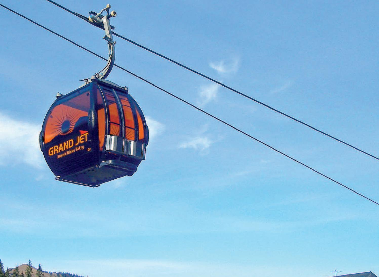
Die 8-MGD Chopok Západ ist die erste Gondelbahn der Welt mit orangen Scheiben. Die Gondeln sind mit Scheibenschutzfolien und zusätzlichen Klappfenstern an der Stirnseite ausgestattet.
