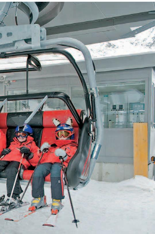
eine Sitzmarkierung angebracht (bei der SunnAlm-Bahn der Steinbock – das Signet des Betreibers). Diese Markierung muss nach dem Hinsetzen zwischen den Beinen sichtbar sein, so dass Platz für den Schließbügel-Schließmechanismus gegeben ist.
