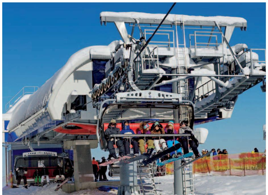
*Die Imberg-Bahnen verstehen sich als Skiparadies für Familien und Genießer. Der neue Fluhexpress mit seinen beheizbaren Bubbles und der Schließbügelverriegelung mit Fußraster wird diesem Anspruch voll und ganz gerecht.*
