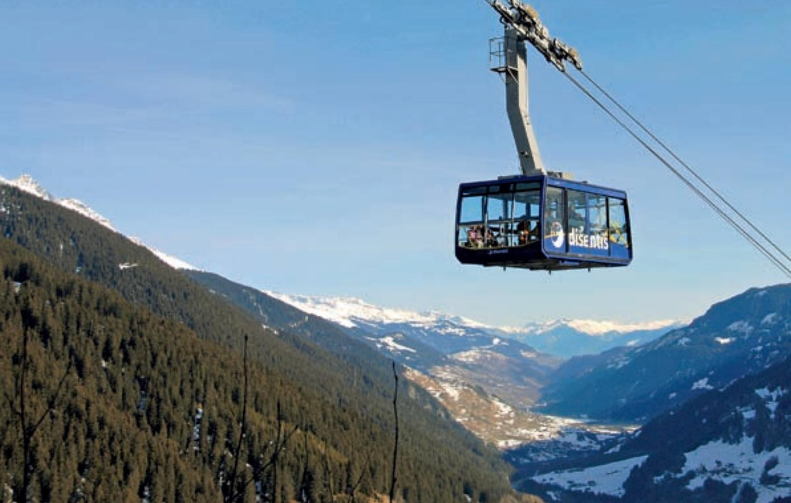
Die Pendelbahn Disentis ist die erste EN-zertifizierte, Fangbremsen-lose Pendelbahn in der Schweiz.
