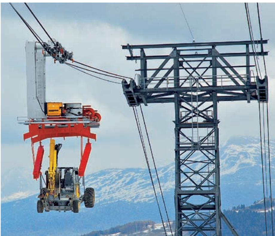
Die Tragkraft der Transportbahn von Tracouet entspricht der einer Kabinenbahn für 187 Personen
