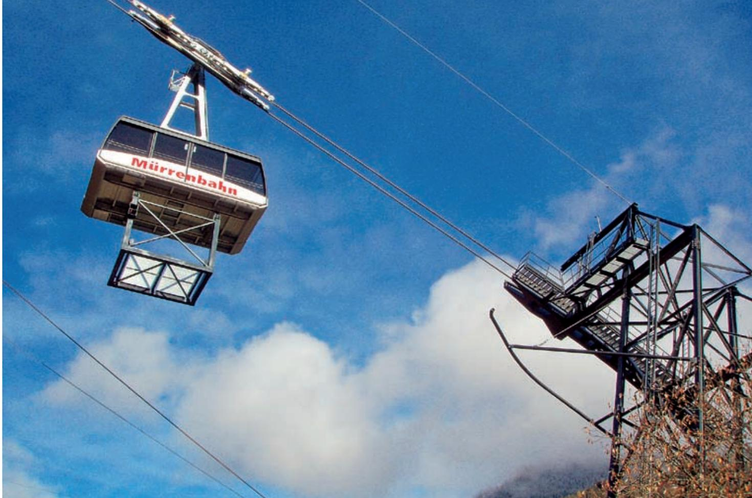
Die Grütschalpbahn gehört zur Jungfrau-Holding. Sie führt von 800 m auf 1.486 m Seehöhe. Die vier Stützen haben eine Höhe von 25, 42, 48 und 19 m.
