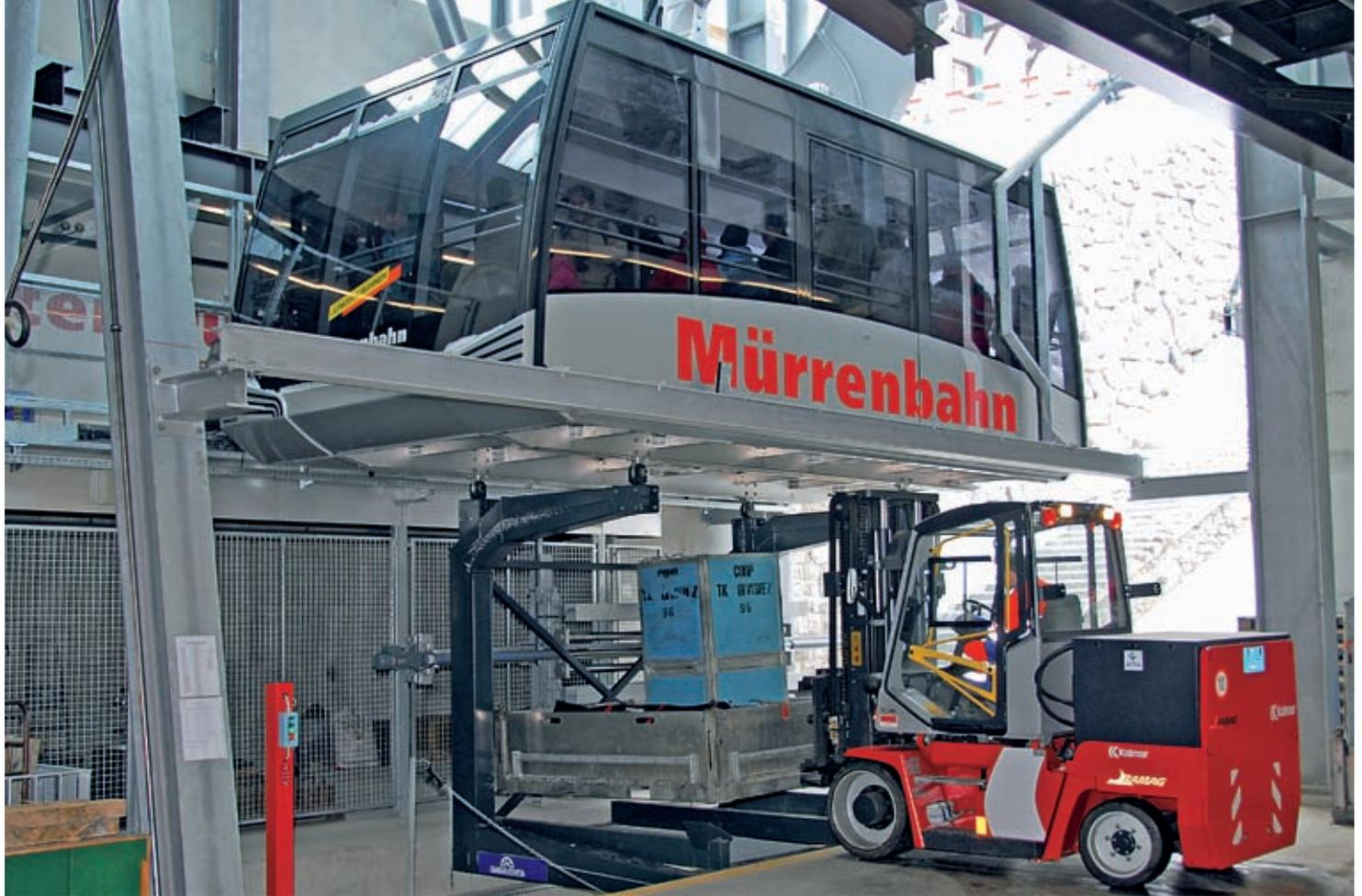
In der Talstation wird die Lastbarelle mit einem Hubstapler be- und entladen. In der Bergstation erfolgt der Materialumschlag von der Pendelbahn auf die Adhäsionsbahn und umgekehrt wie bisher über die bestehende Schrägaufzug-/Stapleranlage.
