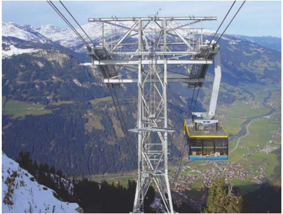
*Komfortable Kabinen: Die Grundfläche der Ahornbahn-Kabine ist mit 38,4 m<sup>2</sup> sensationell; damit stehen jedem Passagier 0,24 m<sup>2</sup> zur Verfügung. Die Bahn ist sowohl eine Zubringerbahn als auch eine Beschäftigungsbahn.*
