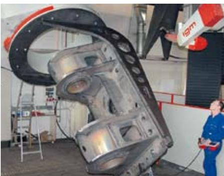
Schweißroboter IGM schweißt bis zu 5t schwere Komponenten.
