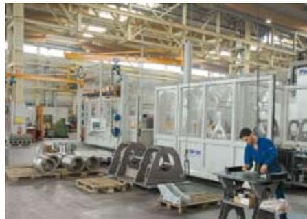
Fahrständer-Fräszentrum SHW Power Speed 5 mit Fahrweg von 16 m.
