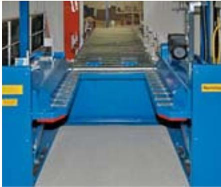
*Von der Palettenaufgabe führt ein Rollenband in das Innere des aus Sicherheitsgründen nicht zugänglichen Hochregallagers; dort werden die Paletten vom Regalbediengerät aufgenommen und eingelagert. In der gleichen Weise erfolgt in umgekehrter Richtung die Auslagerung.*
