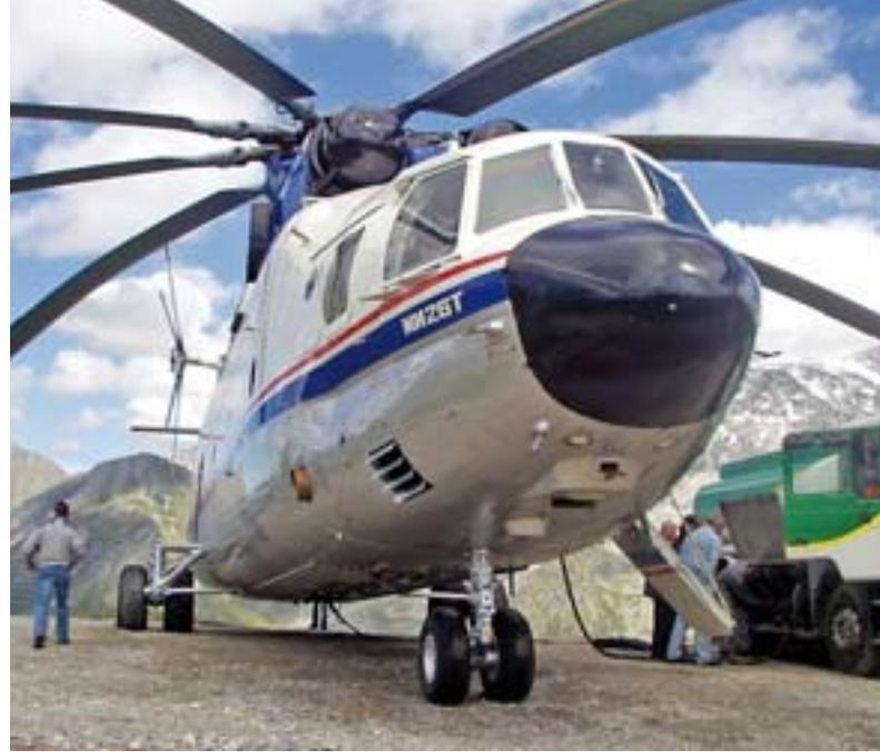
Für die Montage wurde ein Mi26-T eingesetzt, der schwerste in Serie hergestellte Fracht-Helikopter der Welt. Er hat acht Rotorblätter, zwei 8.350kW-Motoren (insgesamt 22.400 PS), ist 46 m lang und kann bis zu 20t Fracht befördern.
