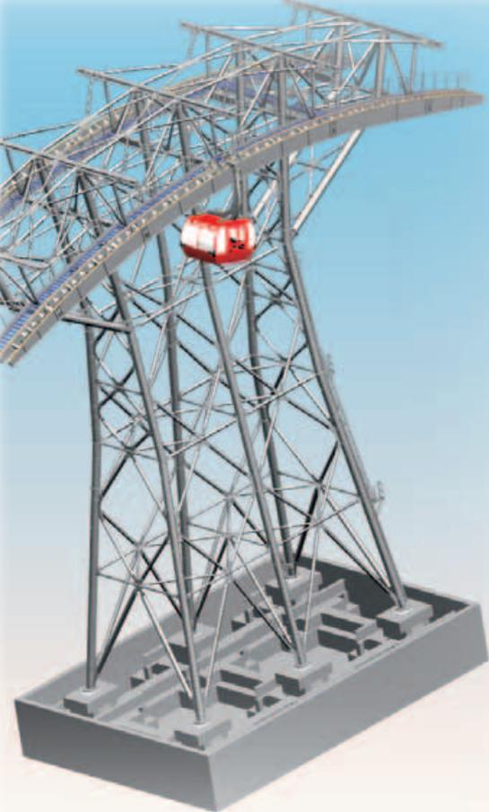
Betonwanne mit hydraulisch in alle Richtungen verstellbaren Fundamenten. Installiert in der Permafrost-Zone bei Stütze III (Bild) und der Bergstation.
