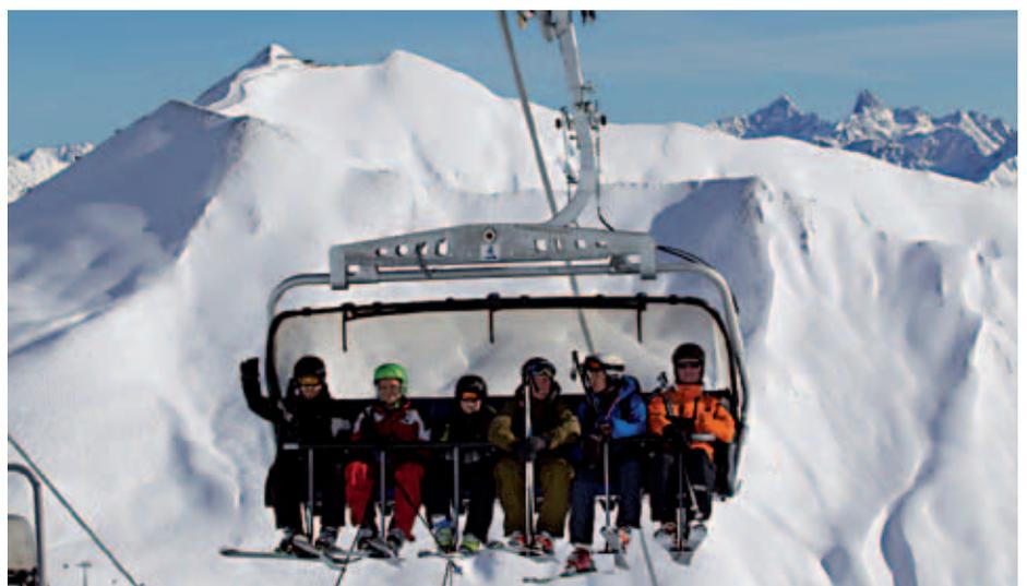
Die Masnerkopfbahn in Serfaus ist die erste, die mit dem neuen Fußauflagesystem FMV von Doppelmayr ausgestattet ist. Die Sessel verfügen über eine mittige Fußauflage und Sitzteiler. Der Schließbügel wird manuell betätigt und verriegelt sich bei ordnungsgemäßer Schließung. In der Bergstation wird die Verriegelung automatisch deaktiviert; erst dann kann man den Schließbügel - wiederum händisch - öffnen. Die Verriegelung der Sessel wird nicht überwacht.
