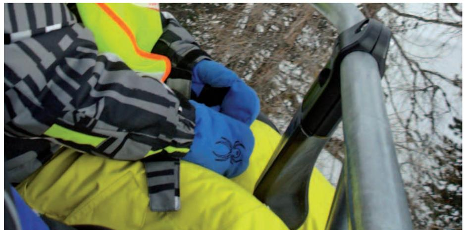
*Retrofit-Kit: Der Zapfen für die Durchrutschsicherung ist an den Schließbügel geklemmt. Skigebiet Nauders am Reschenpass.*
