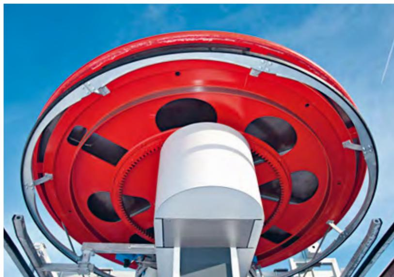
Pour l'entraînement également, plusieurs options s'offrent à votre télésiège fixe. En gare aval ou en gare amont, il peut être aérien ou souterrain, ou encore en version standard compacte Chair-Drive. Cette dernière se distingue par la disposition ordonnée des composants et par la structure compacte, ce qui rend le montage et le transport très simples et rapides.
