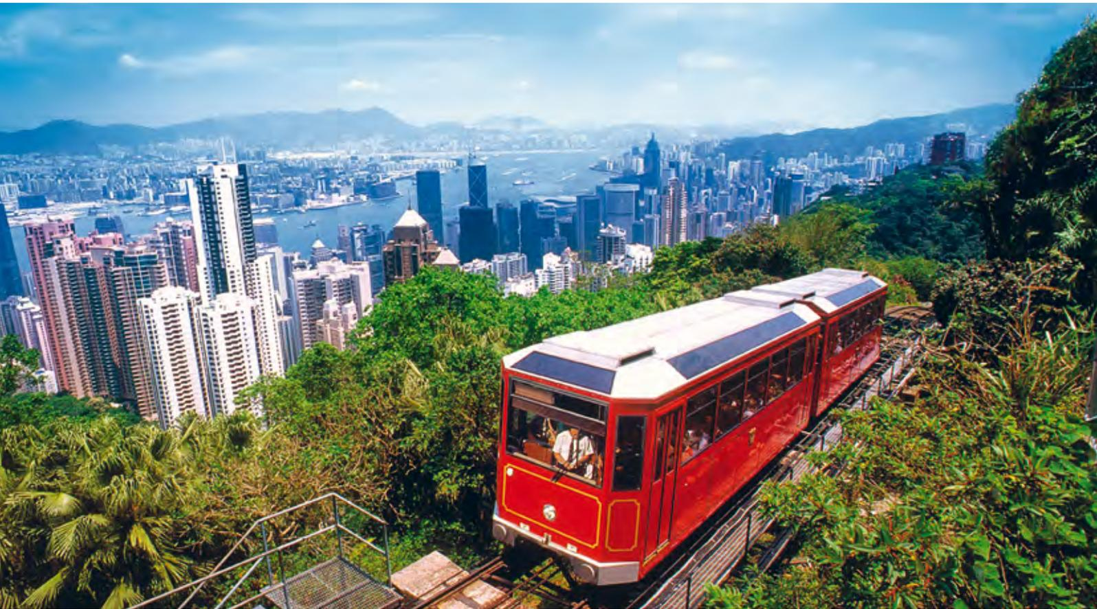
A diferencia de otros sistemas de teleféricos, el funicular ofrece la posibilidad de trazados muy diversos. El recorrido puede ser recto o tener curvas y pasar por puentes, viaductos y túneles. Como fundamento del recorrido pueden utilizarse suelos clásicos de balasto, vigas de acero o construcciones de hormigón. Los raíles se fijan en el fundamento con sujeciones especiales a intervalos de 80 cm. Los rodillos del trazado se encargan de garantizar el recorrido perfecto del cable tractor.
